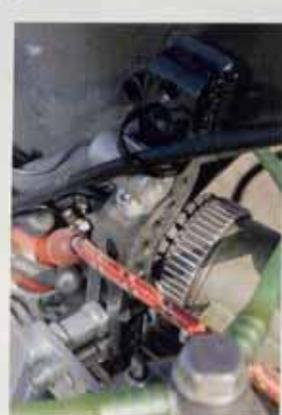
• Il carburatore Dell'Orto SSI 38 a vaschetta separata ha il diffusore da 38 mm e monta un conetto d'aspirazione dritto e non a tromboncino grazie ad una modifica che effettuava lo stesso Zanzani. Il corpo del carburatore poteva essere coperto con una protezione di stoffa plastificata (foto qui a destra), fissata con un elastico al telaio e con un'asola all'attacco del frenasterzo.
