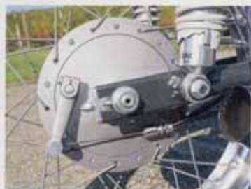
• Tutte le "Sei Tiranti" hanno utilizzato sospensioni Ceriani. La forcella è da 35 mm e contiene 135 cc di olio SAE 30W/40 per ogni stelo. Al posteriore invece il forcellone oscillante lavora con due ammortizzatori idraulici Ceriani, regolabili su 5 posizioni di precarico molla. Sul forcellone sono visibili anche i due registri tendicatena, con la vite di regolazione che lavora su una piastra in lega leggera con dado e controdado.
