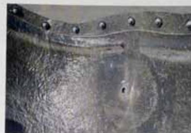
• Alcuni particolari che mettono in evidenza la cura certosina con cui venivano preparate da Zanzani le "Sei Tiranti", alla perenne ricerca di qualche grammo da risparmiare: il serbatoio in lamierino d'alluminio o in vetroresina con tappo a vite in ertalon (o nylon 6, una resina poliammidica); il rinforzo in teflon in prossimità delle viti della carena, annegato in essa e il sottilissimo parafrangente posteriore. Il foro serve per il passaggio del filo del freno posteriore.
