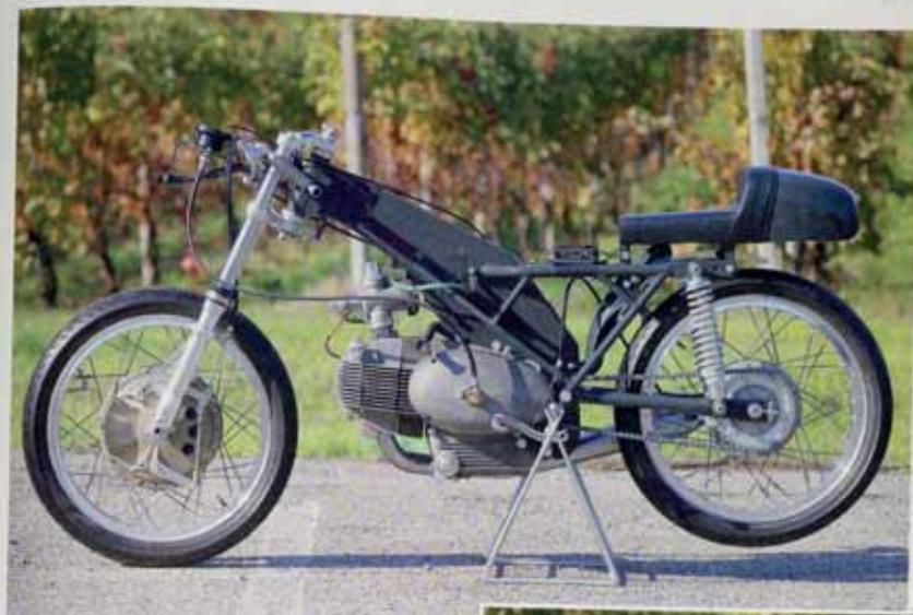
• Il telaio della "Sei Tiranti" in apparenza è il monotrave in lamiera stampata della Sprite di serie, a cui viene applicato il traliccio posteriore di rinforzo in tubi d'acciaio e modificate le sedi del canotto di sterzo per ospitare cuscinetti di maggiori dimensioni. In realtà, per risparmiare peso, lo spessore della lamiera è inferiore a quello dei telai stradali. La parte superiore della trave è poi irrigidita con saldature. La capacità del serbatoio della benzina è di 16 litri.
