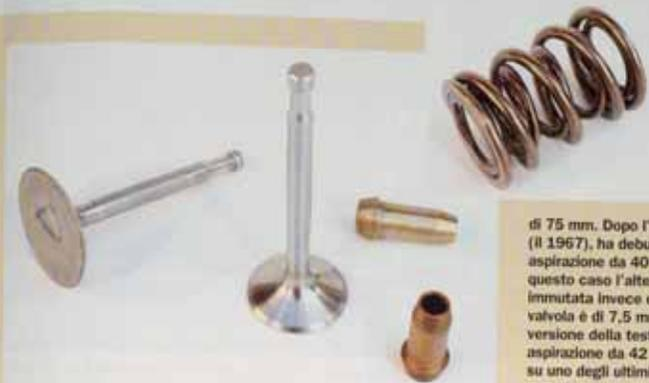
• Le valvole con le relative doppie molle e le guide valvole in bronzo. Realizzate al sodio per migliorarne il raffreddamento, sono state utilizzate in diverse misure. Inizialmente (nel 1966) quella di aspirazione aveva un diametro di 39 mm, mentre quella di scarico era da 33 mm. In questa versione l'altezza della valvola di aspirazione è di 72 mm, quella di scarico
