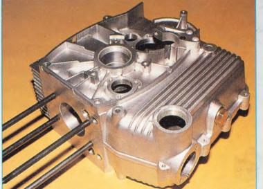
Il basamento è fuso in terra e ospita il cam ravvicinato a smarce. Nella pinferiore, a differenza de basamenti di serie, si not un tappo aggii in bronzo per lo scarico dell'
